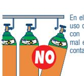
En el área de almacenamiento o uso de cilindros, no debe contar con instalaciones eléctricas en mal estado y no deben estar en contacto con los cilindros.
