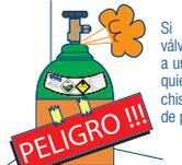
Si detecta alguna fuga en la válvula de un cilindro, mueva éste a un área abierta y lejos de cualquier fuente de ignición (calor, chispas, flamas); coloque señales de prevención y llame a INFRA®.
