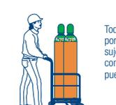
Todos los cilindros deben transportarse en posición vertical, sujetos a un carro portacilindros y con su capuchón de seguridad puesto.
