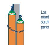
Los cilindros en uso deberán mantenerse en posición vertical sujetos a un poste, columna, pared o carro portacilindros.
