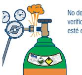
No desconecte los cilindros hasta verificar que la presión siempre esté en ceros.
