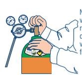
Nunca purgue (ventile), ni abra la válvula del cilindro sin instalar el regulador. Colóquese a un lado del regulador cuando abra la válvula del cilindro (nunca de frente).
