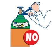
Prohibido cambiar o forzar las conexiones de un cilindro o un dewar. Si éstas no acoplan con las de sus equipos o líneas de consumo, no las fuerce, llame a INFRA®.
