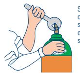
Siempre utilice el material adecuado al conectar los cilindros a sus equipos; recuerde que es obligatorio el uso adecuado según el tipo de gas.
